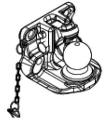
Der Befestigungsflansch in den Ausführungen 1 und 4 ist für einen Schraubanschluss 140\*80 – M16, der in den Ausführungen 2 und 5 für Schraubanschluss 140\*80 – M20 und der in Ausführung 3 und 6 für Schraubanschluss 160\*100 – M20 vorgesehen.
